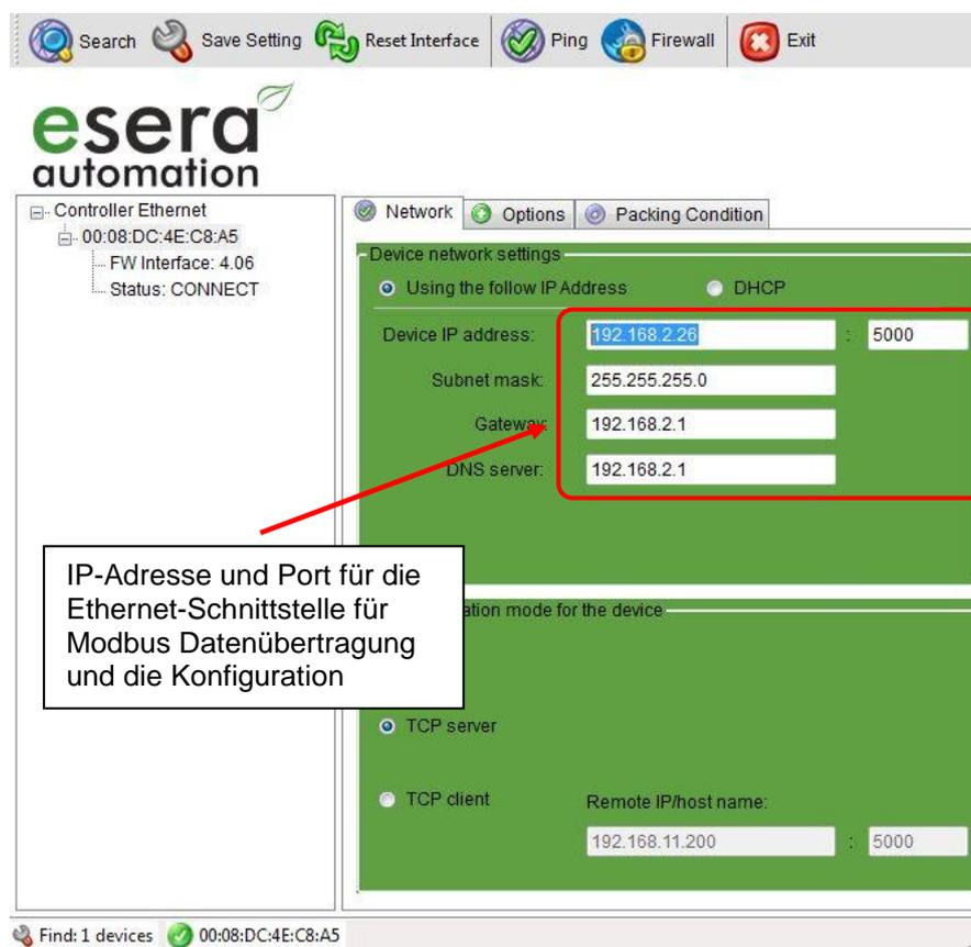
IP-Adresse und Port für die Ethernet-Schnittstelle für Modbus Datenübertragung und die Konfiguration
